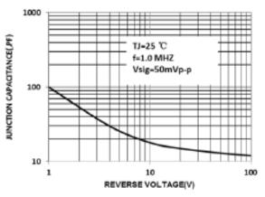
FIG5-Typ REVERSE CHARACTERISTICS
